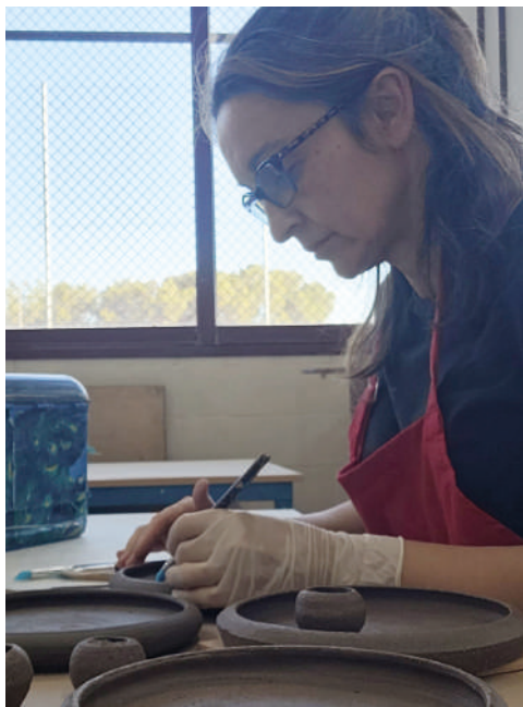
Colocación manual de esferas cerámicas sobre el plato en estado de cuero
